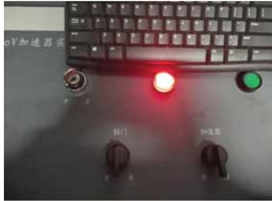
照片 14 操作台上急停开关及钥匙开关
