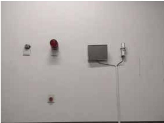
照片 9 固定式剂量监测仪探头
